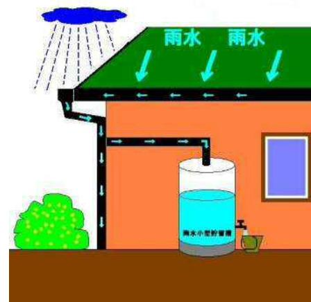
雨水小型貯留槽とは、屋根に降った雨水を雨どいから貯めるタンクです。タンクに貯めた雨水を庭木の水やりや道路の散水等に利用できます。
