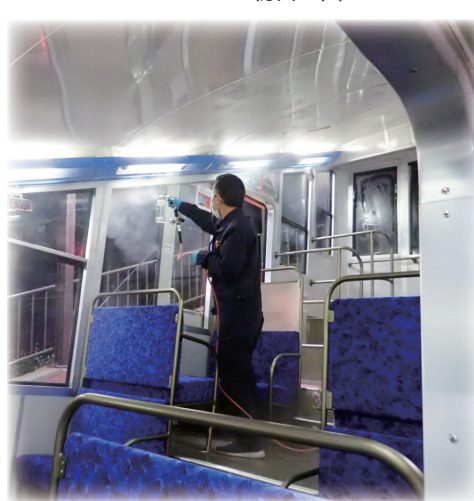
△ケーブルカー車内の抗ウイルス・抗菌施工
