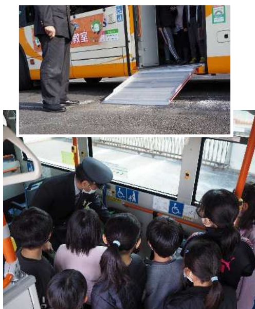
車いすの乗車方法 (反転式スロープ板と車いす固定装置を見学)
