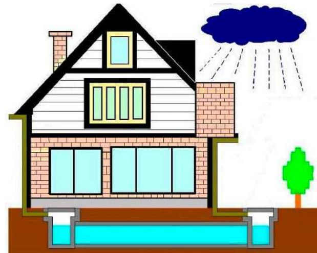
雨水浸透施設
